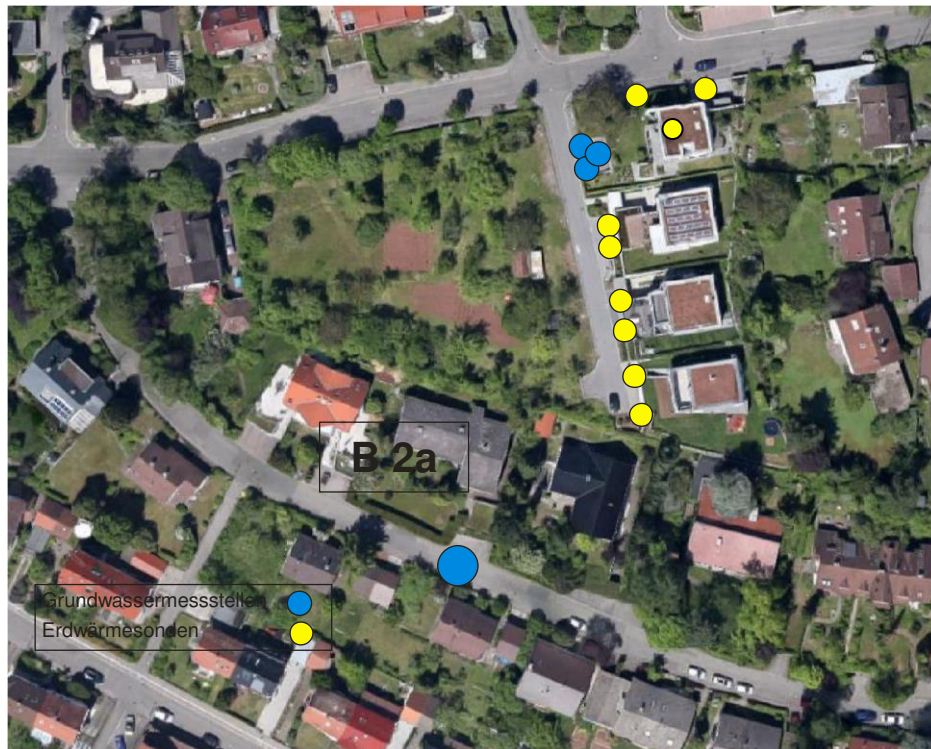
Abbildung 3: Blick auf den Bohrpunkt in der Kniebisstraße mit Lage der im Heinrich-Heine-Weg errichteten Erdwärmesonden und Grundwassermessstellen (Basis: Google Maps)
