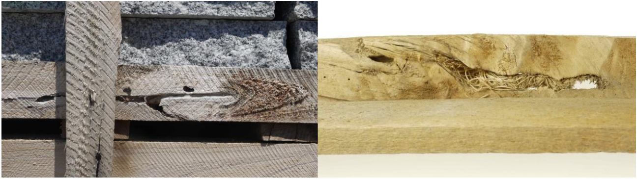
Abbildungen 4 und 5: Larvengänge in dem Verpackungsholz einer Steinladung; rechts mit Genagel und Spänen (Bilder von Wuthenau, LTZ)
